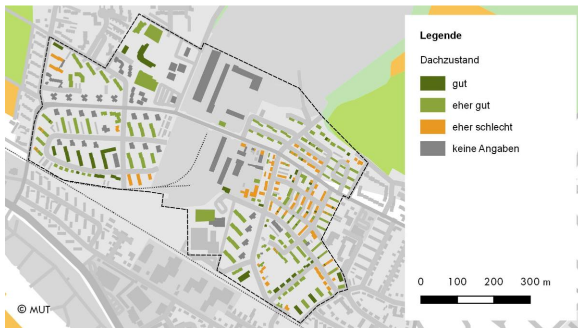
Abbildung 21: Bewertung des Dachzustands
